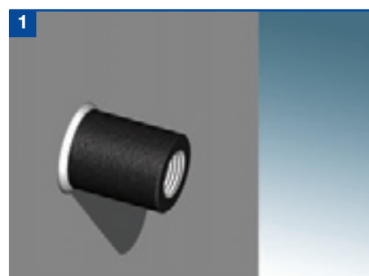
Saldare il manicotto alla struttura in acciaio.
